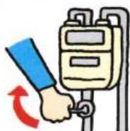
ガスメーターバルブ
